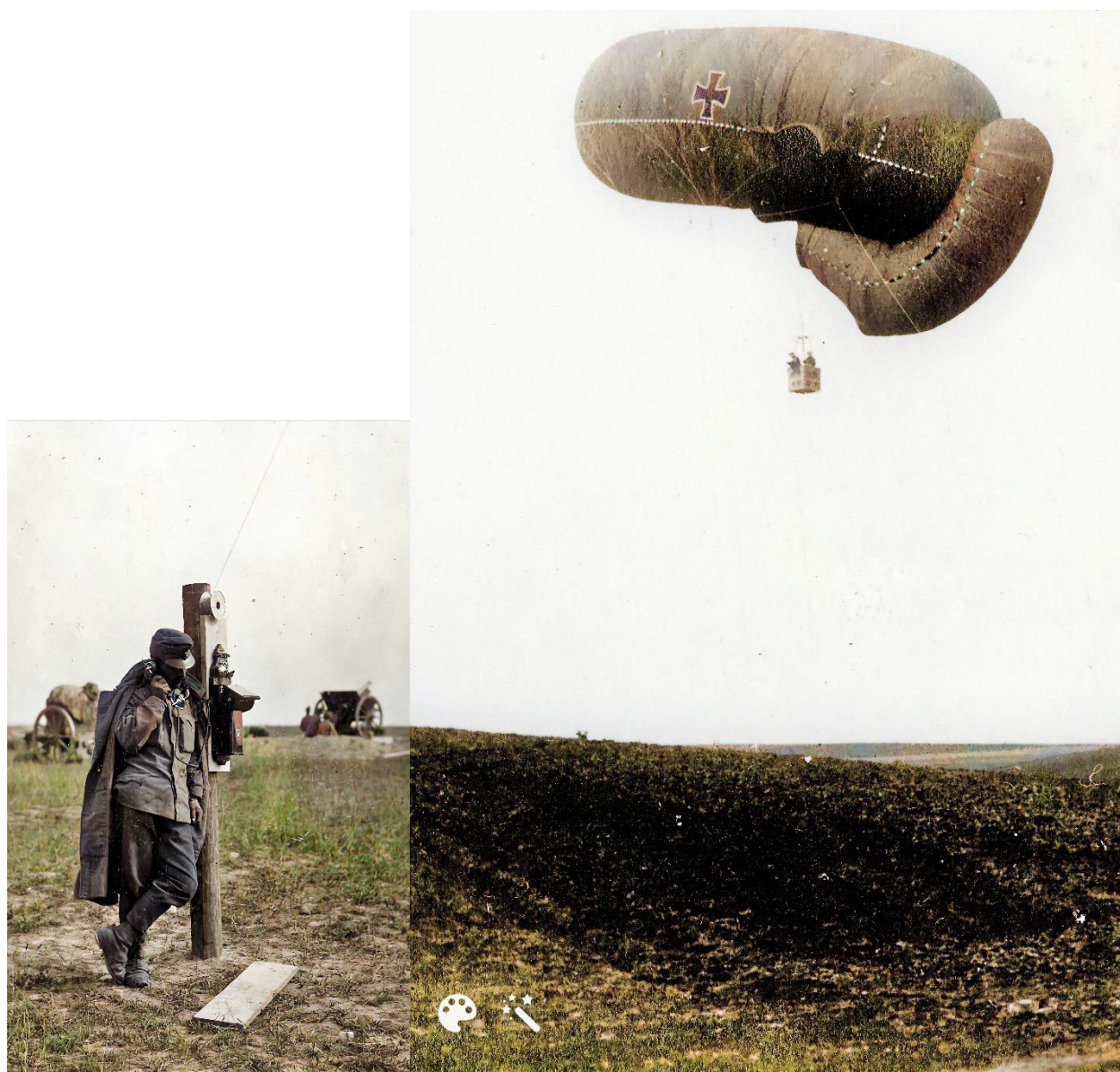
A Monarchia Drachen típusú rögzített tüzérségi tűzvezető ballonja telefonállomással 1917 (A képen az összekötő telefonkábel csak sejthető)
