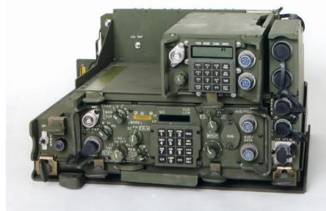
4.ábra: Az Internet Controller (INC) elhelyezkedése a rádiósketben
