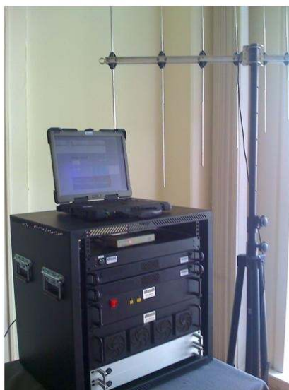
Zavaró (ECM) állomás vázlatos felépítése és labormintája
