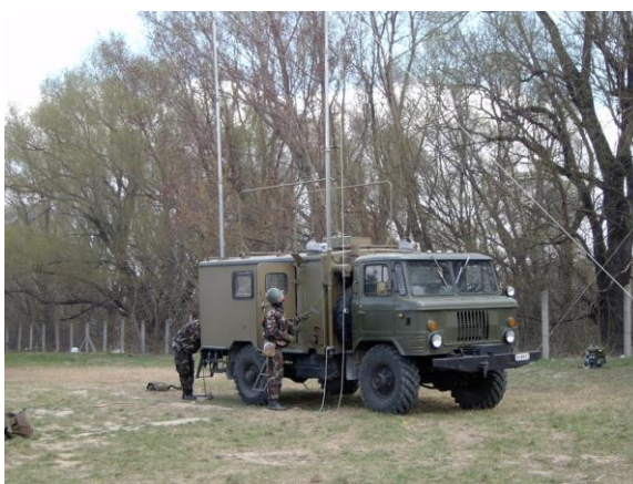
1. kép: Az R-142 rádióállomás telepítése Forrás: A szerző felvétele
